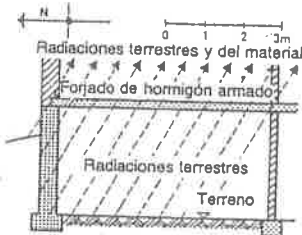
5 Los forjados de hormigón armado dejan traspasar las radiaciones procedentes del suelo (refraciéndolas) → pág. 29 7
